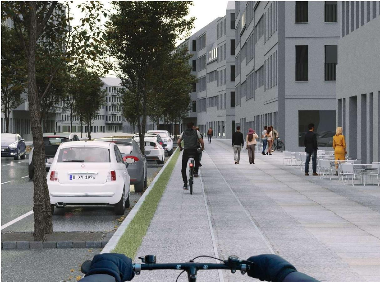
Als dritte Möglichkeit kann sich links der Radverkehrsanlage eine Grünanlage bzw. Trennung zum Kfz-Verkehr befinden. Diese wird mit einer hohen dichten Hecke dargestellt.
